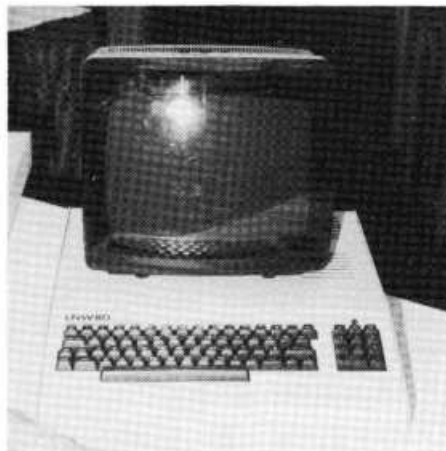
Afb. 4. Aan de buitenkant lijkt de LNW 80 in geen enkel opzicht op de TRS 80, qua software zijn ze echter volkomen gelijk.
